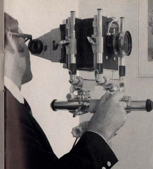
Bei engen Raumverhältnissen kann jeder Zentimeter Aufnahmeabstand ausgenutzt werden. Die Kamera wird am äußersten Ende des Raumes aufgestellt und die Bildeinstellung kann nun von jeder Seite her vorgenommen werden. Ein Vorteil, der bei Aufnahmen von Innenarchitekturen und bei Industrieaufnahmen nicht zu unterschätzen ist.
